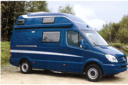
Toit rigide SCA 472 sur Mercedes Sprinter, e. m.
