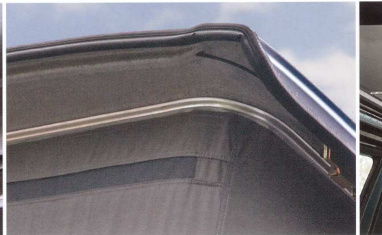
Soufflet en tissu avec bords renforcés et rail en aluminium
