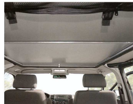
Panneau coulissant pour fermer la trappe
