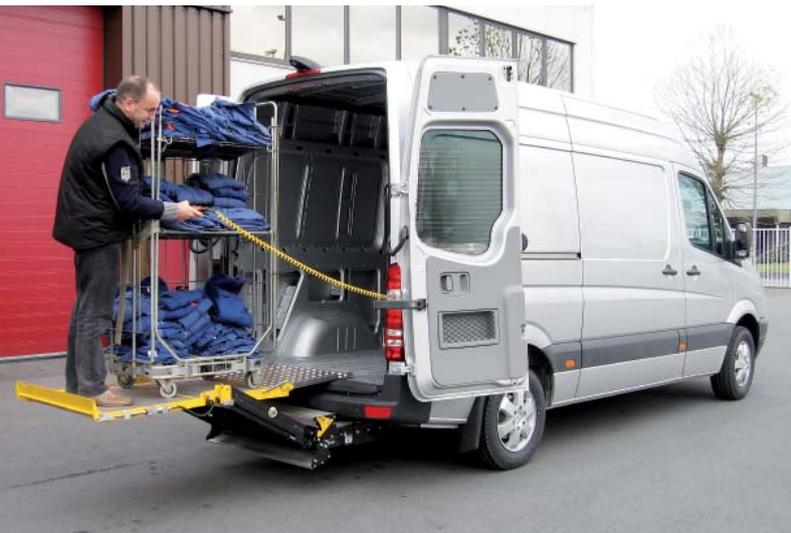
Le hayon à cassette DH-C001 se range proprement dans un caisson de cassette étanche sous le plancher du véhicule. Cette solution permet de **préserv**er l'accès par les portes arrière et ne consomme pas d'espace à l'intérieur du véhicule.
