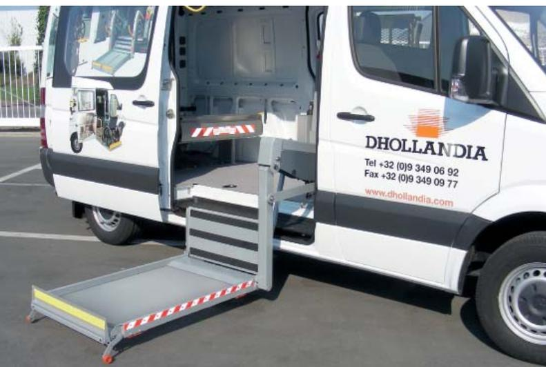
Le DH-P1 est un **hayon à simple bras linéaire**. Il se monte à l'intérieur de la porte arrière ou des portes latérales d'un large choix de monovolumes et fourgons.
