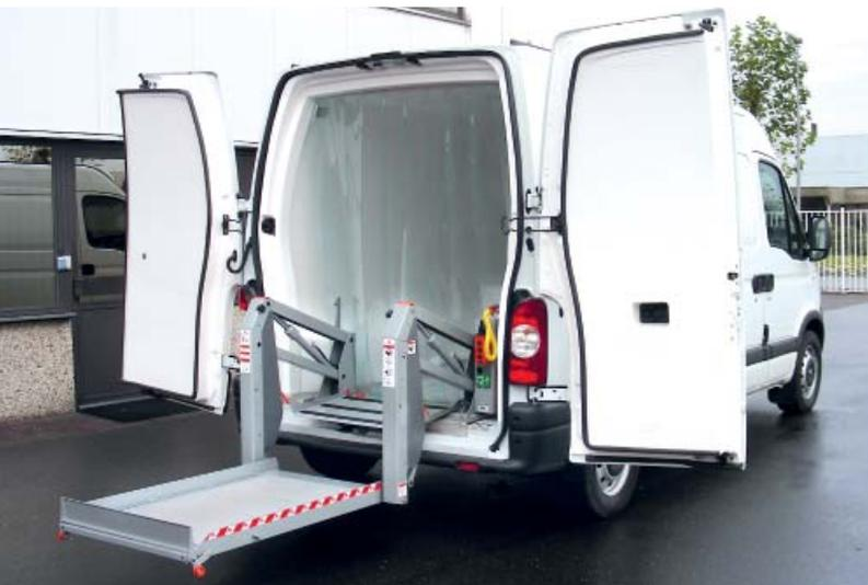
Le DH-P2 est un **hayon linéaire entièrement automatique**. Il s'installe **dans l'espace de chargement** du véhicule. Au niveau des portes arrière, ou au niveau des portes latérales d'un large choix de monovolumes et de fourgons.
